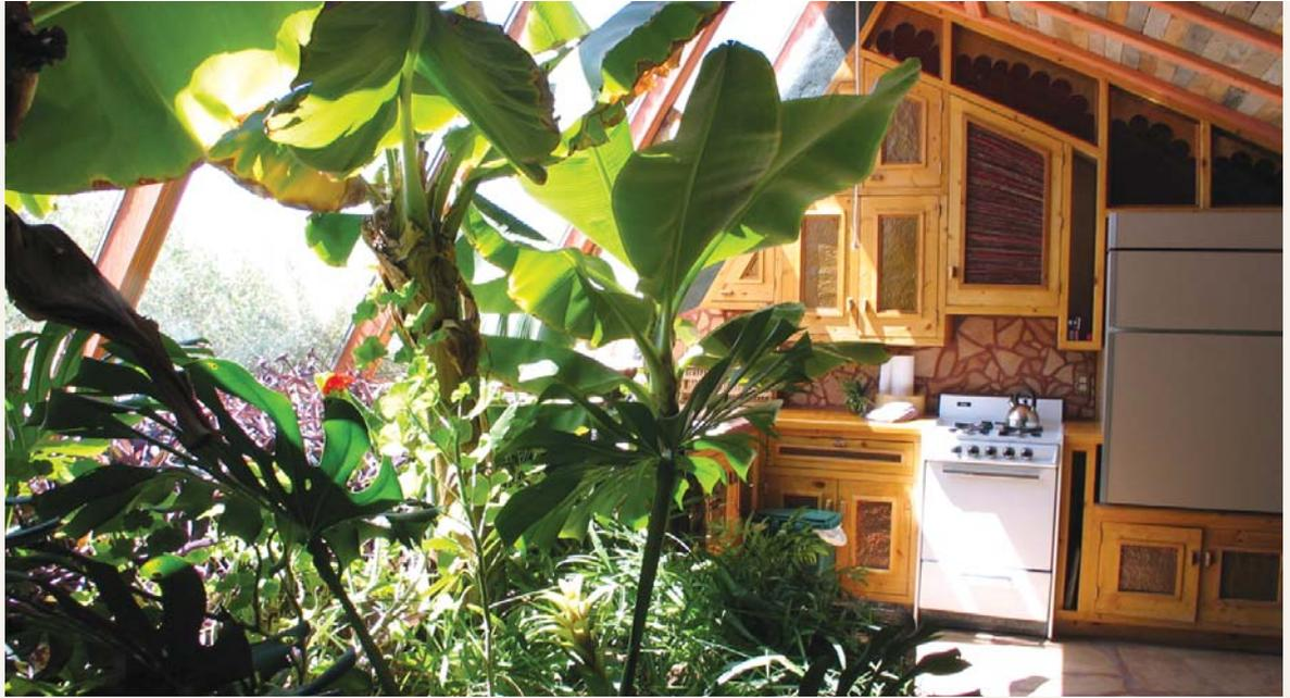
**Malgré le fait qu'elles sont enfouies, les maisons Earthship sont très lumineuses. Tout le côté sud est vitré et les chambres, généralement placées au nord dans une maison solaire passive, pourront être dotées de puits de lumière, tel le Solatube de forme cylindrique.**
