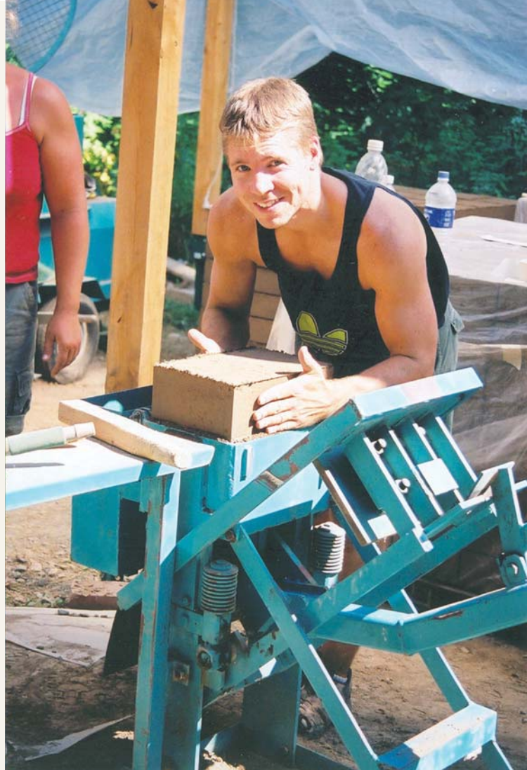
L'appareil artisanal pour la compression de la terre en blocs, sur le site du Centre culturel et récréatif d'Otterburn Park. Il appartient à Ginette Dupuy, dont l'étude sur cette technique de construction a été financée par la SCHL.
