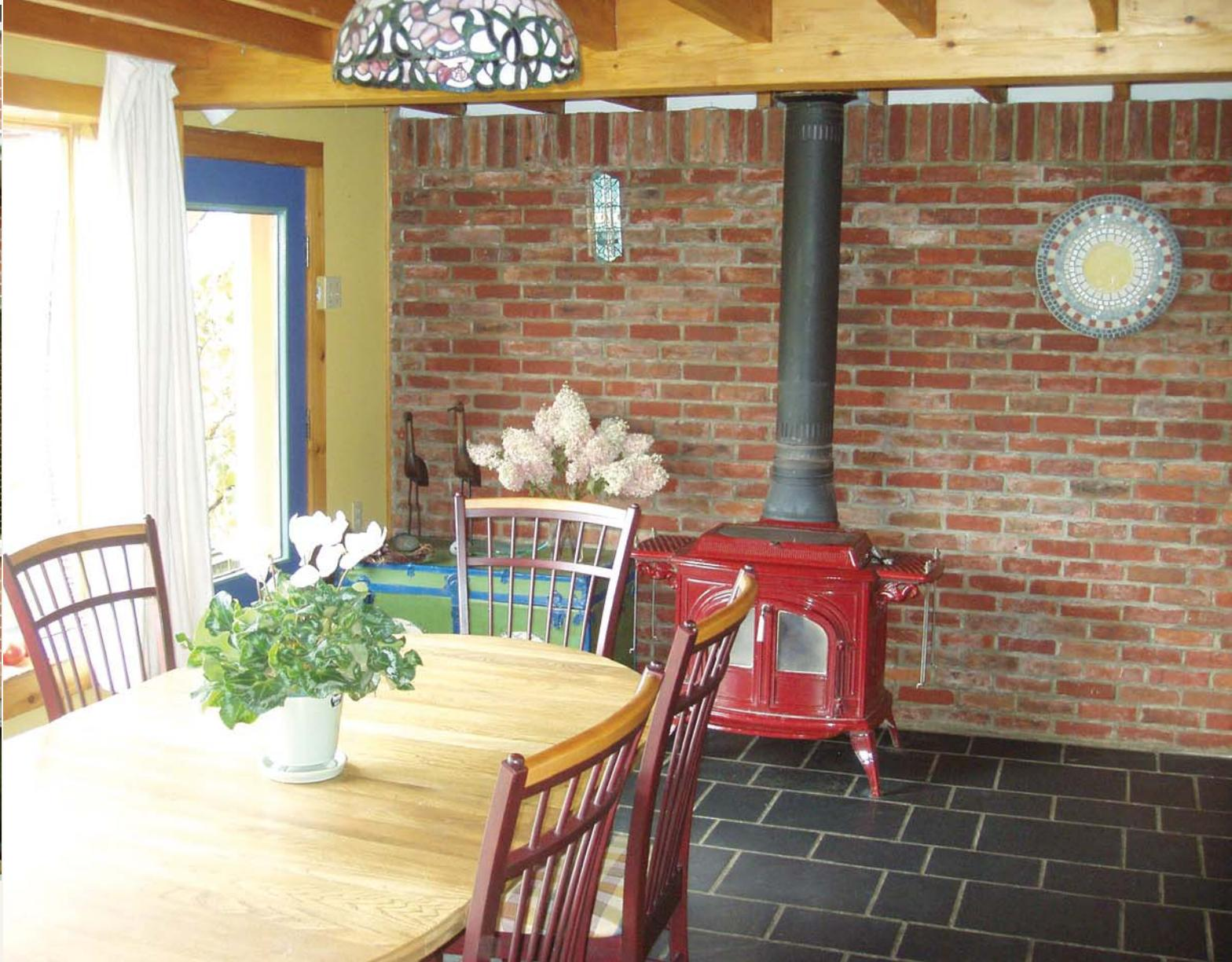
*La salle à manger de la maison Muyldermans est dotée d'un plancher d'ardoise qui accumule la chaleur des rayons solaires qui le frappe. De même, les rayons infrarouges émis par le poêle à bois en fonte réchauffent une autre masse thermique : le mur de brique.*
