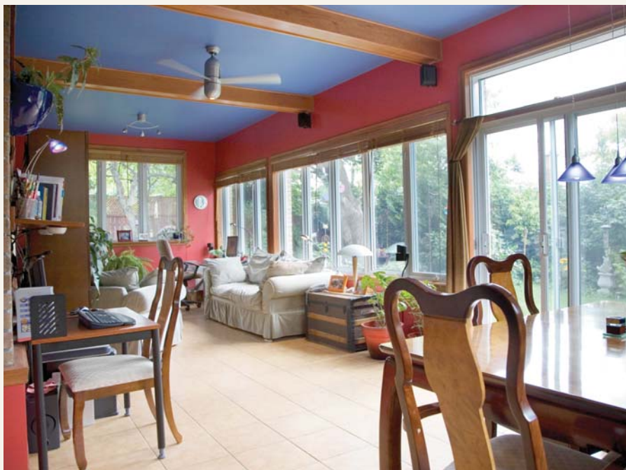
L'agrandissement d'une résidence à Pierrefonds avec une pièce de séjour conviviale orientée sud profitant au maximum du soleil de l'hiver. L'été, les débords de toit protègent de la surchauffe, permettant d'utiliser cette pièce à longueur d'année.
