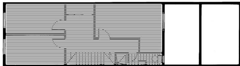
Expansion verticale de 49,6 m<sup>2</sup> additionnels par l'ajout d'un second niveau. L'escalier remplace l'espace de rangement du rez-de-chaussée.
