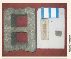
L'oxyde de magnésium (OMg) permet de fabriquer des matériaux à faible toxicité qui sont légers, durables, résistants au feu et aux moisissures. Ce type de ciment permet de lier tout matériau cellulosique et il requiert 80 % moins d'énergie à fabriquer que le ciment Portland.
